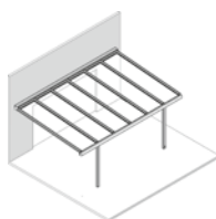
B2 bündig, Pfosten eingerückt Flush, posts recessed
